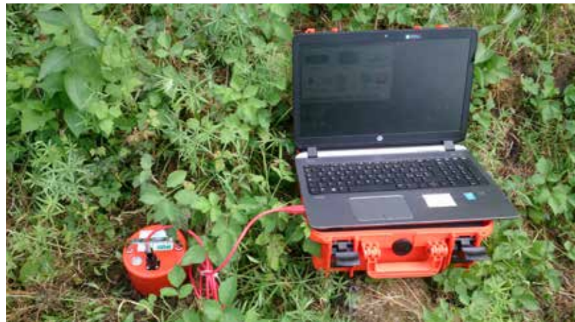
Prova H/V realizzata al centro dello stendimento S2 - lato Paderno
